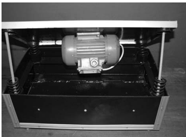
Рис. 1. Віброплатформа зі встановленим під нею вібратором
