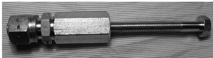
Рис. 2 Ячейка высокого давления в собранном виде (пояснения в тексте)
