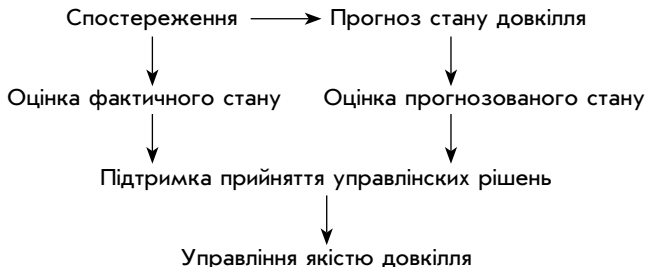
Рис. 1. Структура системи моніторингу довкілля
