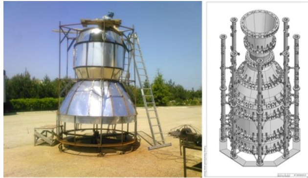
Рис 1. Зовнішній вигляд дослідного зразка та конструкція вертикальної енерговітроустановки ІПЕ «СМЕРЧ»
