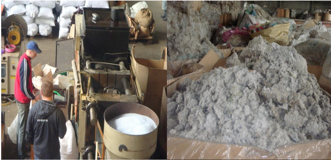
Рис 3. Подріблення та агломерація вторсировини
